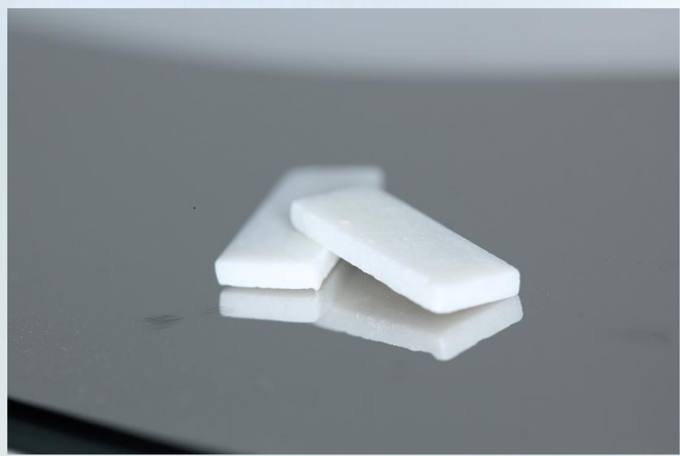
Quarenta placas de zircônia sinterizadas (Katana, Noritake Dental Supply Co) foram preparadas, com medidas de 13 X 5 X 1 mm.
