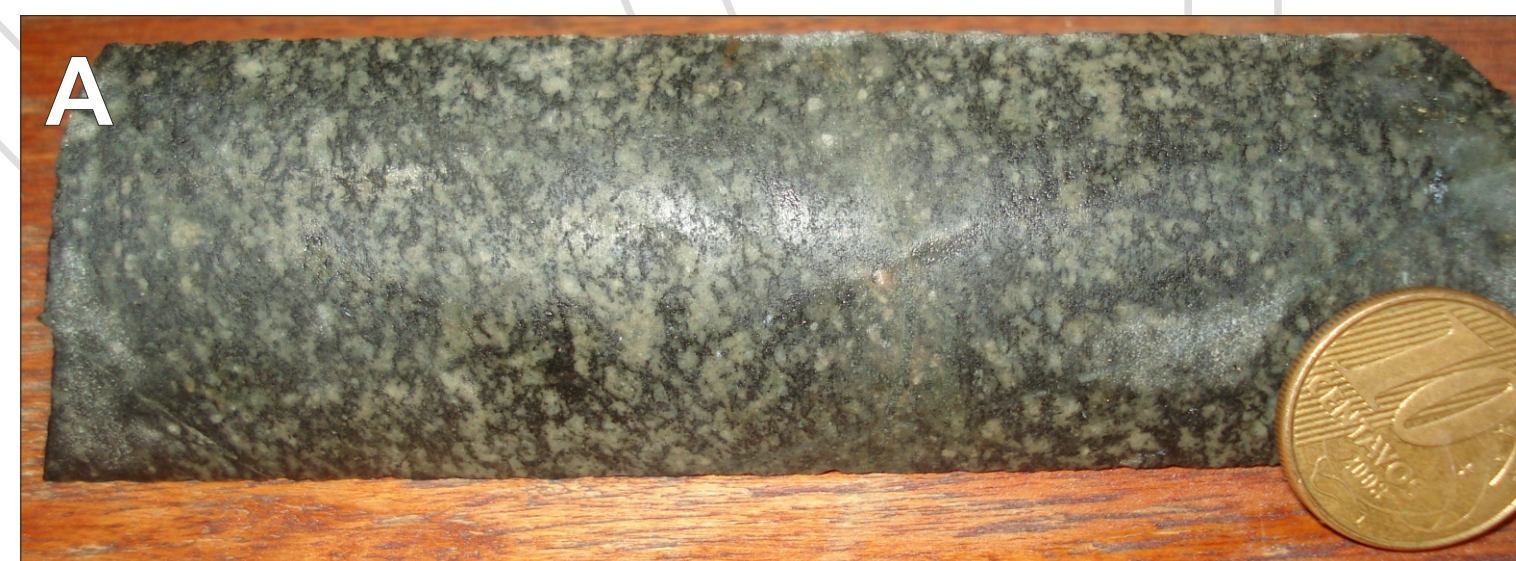
Figura 1. Testemunho de sondagem com textura de rocha ígnea, pouco alterada (apenas alteração potássica por biotita fissural).
