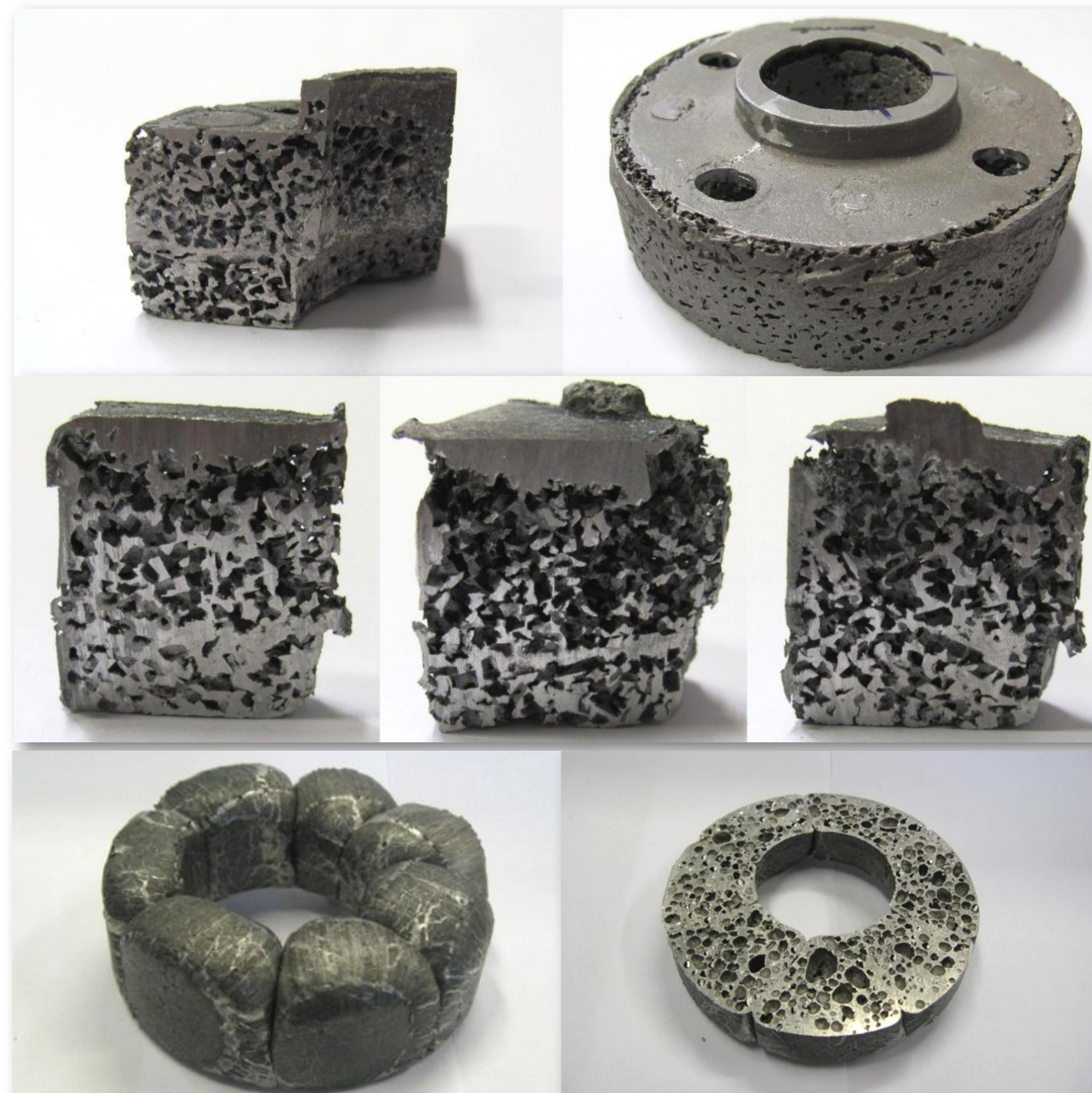
Fig. 1 Amostras dos componentes automotivos porosos fabricados: esponja e espuma metálica (liga AA356).
