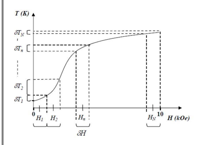
O sinal captado pelo Microfone é proporcional a δT gerado por  $\delta H$  do campo AC, para um campo DC fixo (H).
