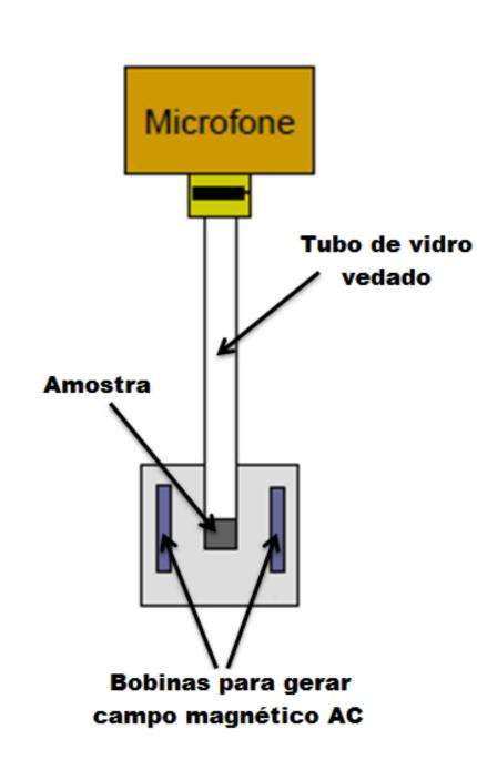
O princípio da magnetoacústica se baseia em gerar oscilações de temperatura na superfície da amostra através de um campo AC, dando origem a ondas de pressão no **tubo de** vidro que são detectadas por um **microfone**.
