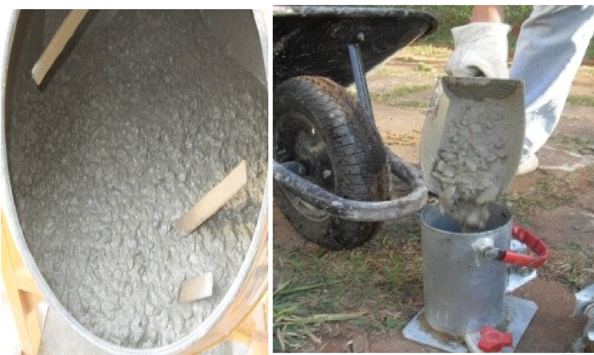
Figura 2- Concretagem e moldagem dos corpos-de-prova cilíndricos
