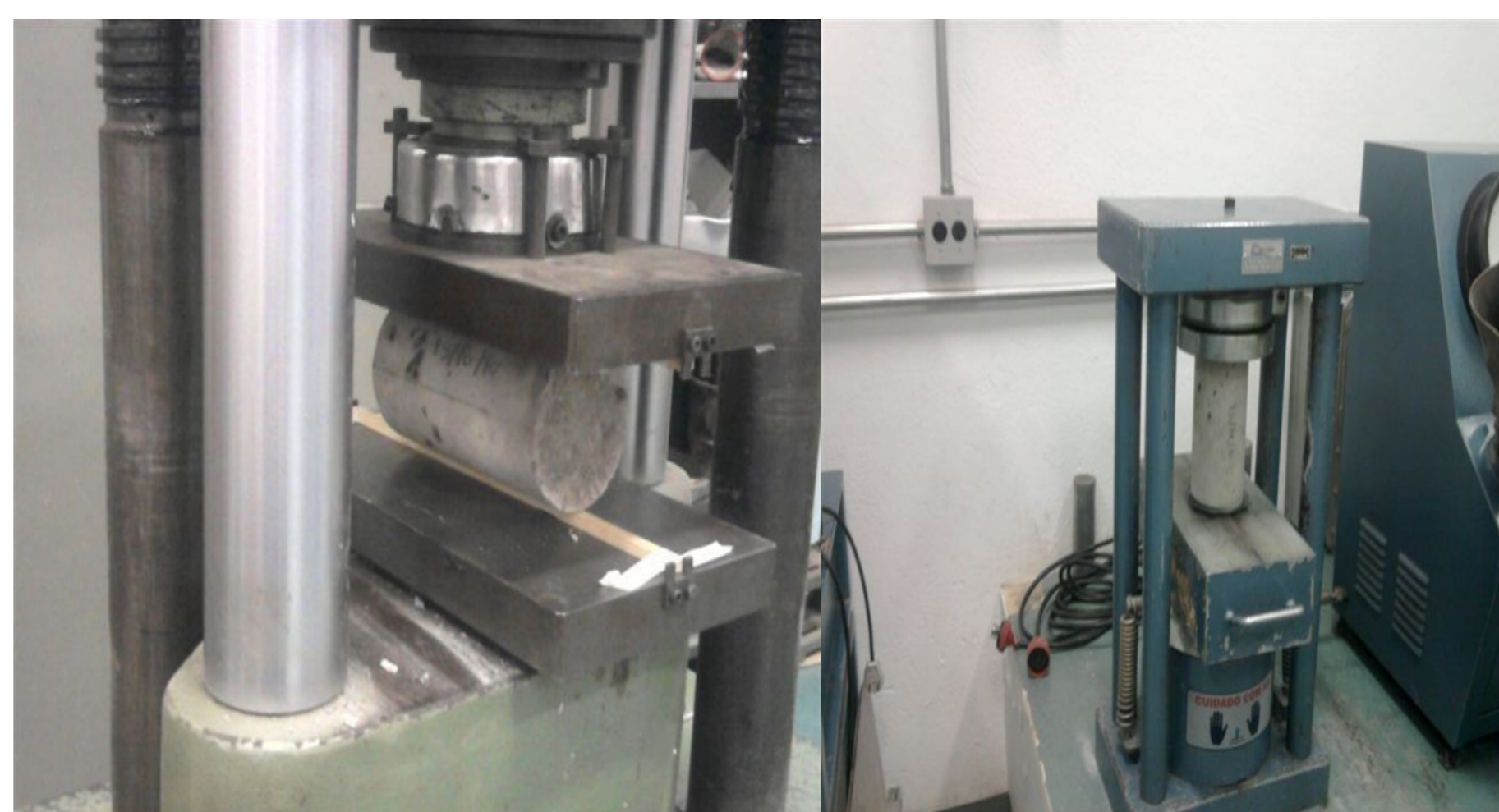
Figura 4 – Determinação da resistência à tração por compressão diametral e resistência à compressão dos corpos-de-prova cilíndricos
