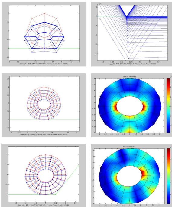
Figura 3: Aplicação do algoritmo de contato e mapa de tensões.
