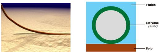
Figura 2: Região de contato riser-solo e, corte típico para análise
