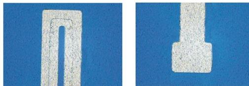
Figura 8 – Fotodiodo pronto (logo após receber camada de metal e ter o fotoresiste removido)
