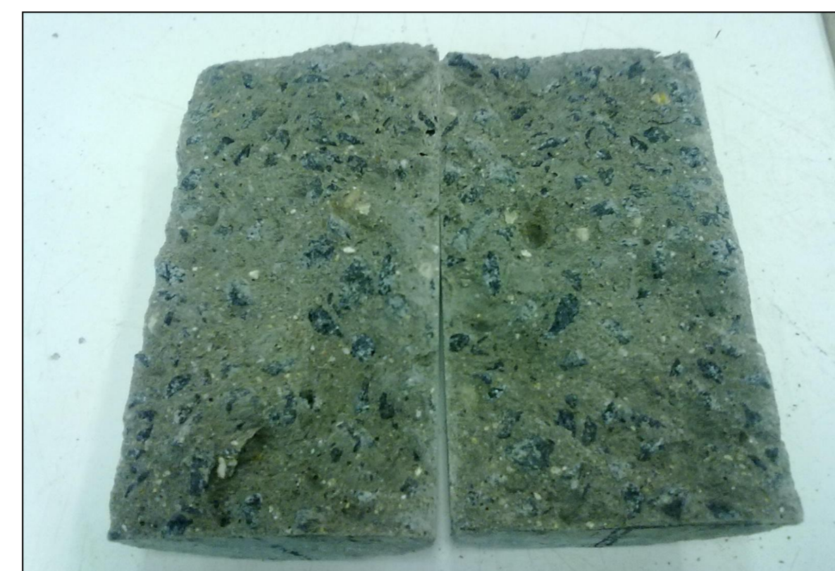
Figura 4 – Corpo de prova cilíndrico rompido
