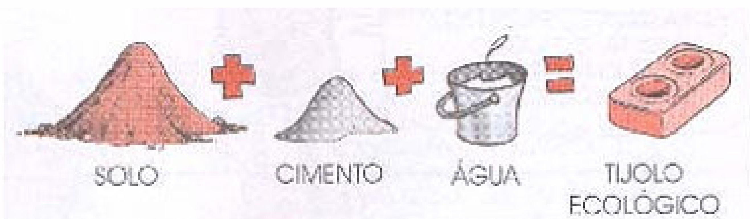
Figura 1 – Componentes da mistura de solo-cimento
