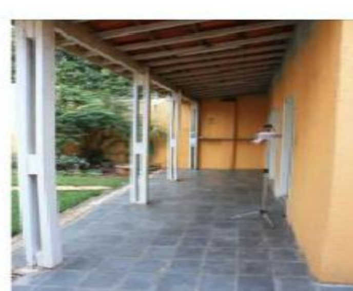
Figura 3: Tripé com data-logger para coleta de temperatura e umidade relativa do ar.
