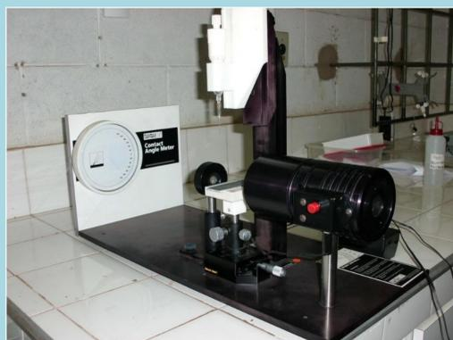
Figura 4: Goniômetro Utilizado no Experimento
