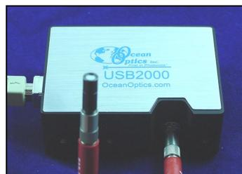
Figura 4- Espectrômetro USB 2000 2-SH.
