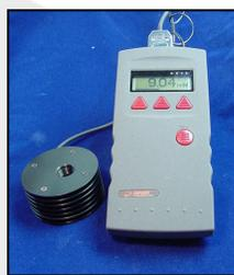
Figura 3- Medidor de potência Ophir 10A-V2-SH.
