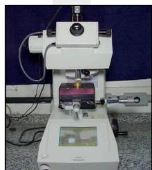
Figura 7- Durômetro (HMV-2000, Shimadzu).
