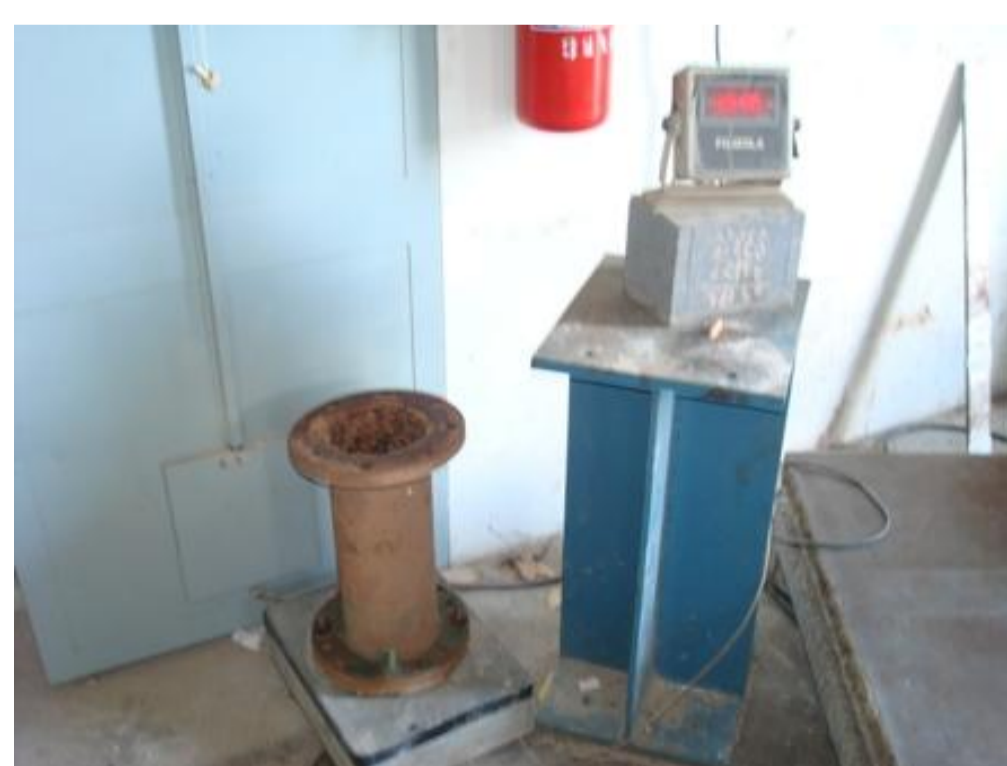
Figura 2 – Pesagem do tubo para a determinação do diâmetro
