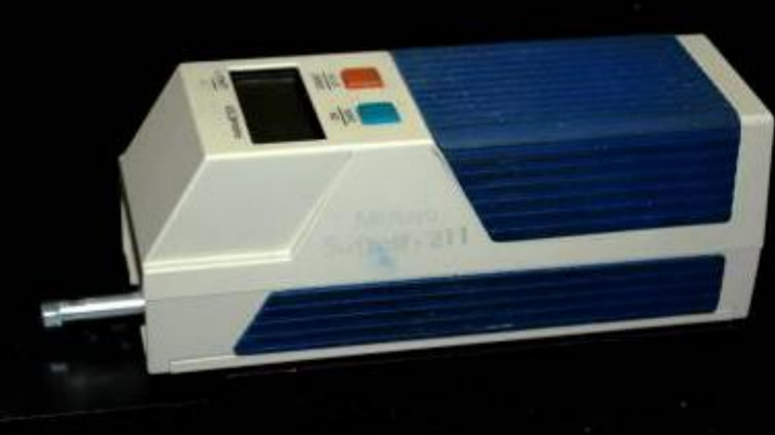
Fig2: Rugosímetro (Mitutoyo, SurfTest 211, São Paulo, Brazil); Direção das leituras
