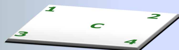
Figura 1. Disposição das cargas dentro da cavidade do forno de micro-ondas.
