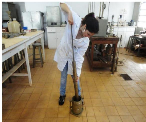
Figura 2 – Ensaio de Compactação
