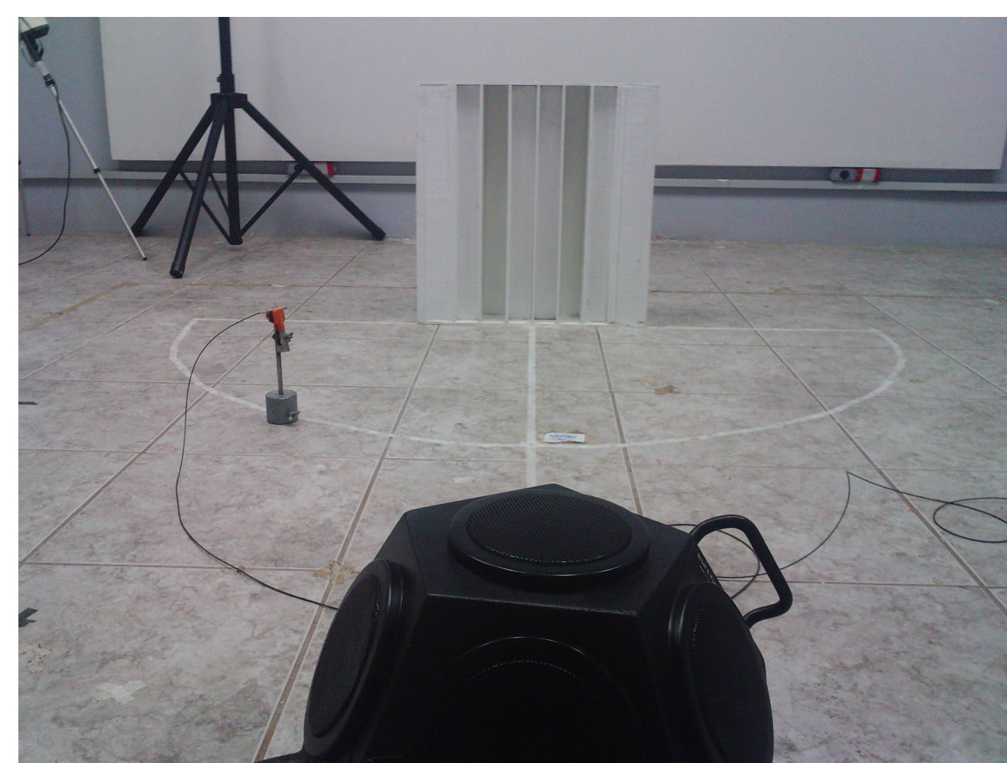
Figura 2: ensaio para determinação de energia sonora difundida para difusor de Schroeder.
