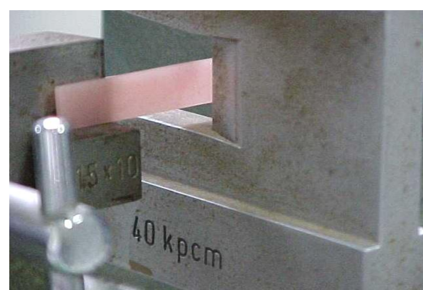
FIGURA 3 – Ensaio de resistência ao impacto
