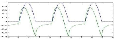
Figura 1- Função e sua derivada em serie de Fourier
