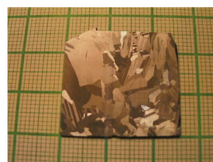
Figura 2: Foto de uma lâmina de Si-GMM policristalina.
