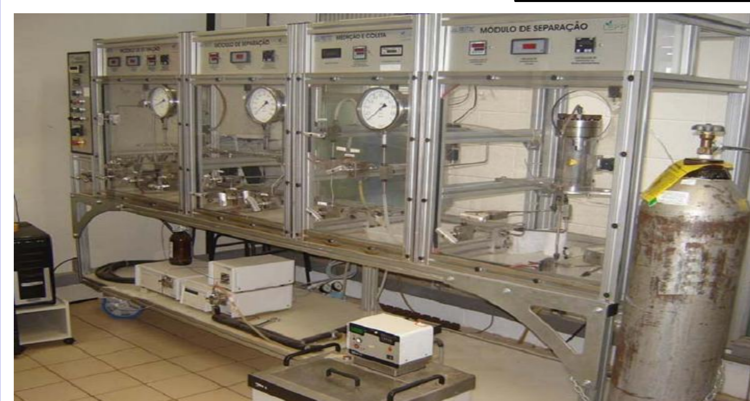
Figura 3: (a) Equipamento para processos com fluidos supercríticos; (b) Diagrama de fluxo simplificado do sistema de esterilização.
