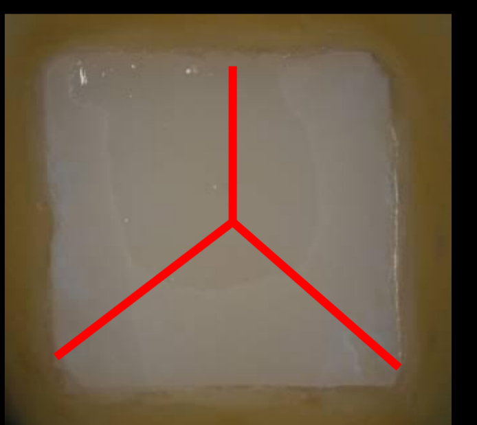
Fig2: Rugosímetro (Mitutoyo, SurfTest 211, São Paulo, Brazil); Direção das leituras
