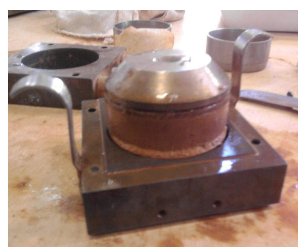
Figura 2- Imagem do ensaio de cisalhamento direto do solo da região de Sorocaba com madeira e inundado
