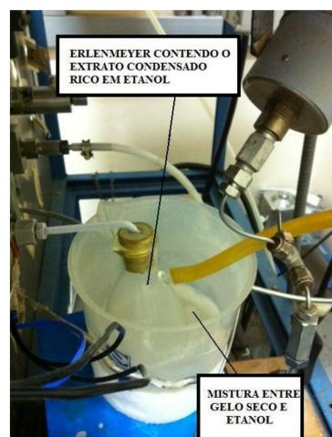
Figura 4: Retrato do sistema de coleta do extrato, composto por um erlenmeyer imerso num banho de etanol e gelo seco.
