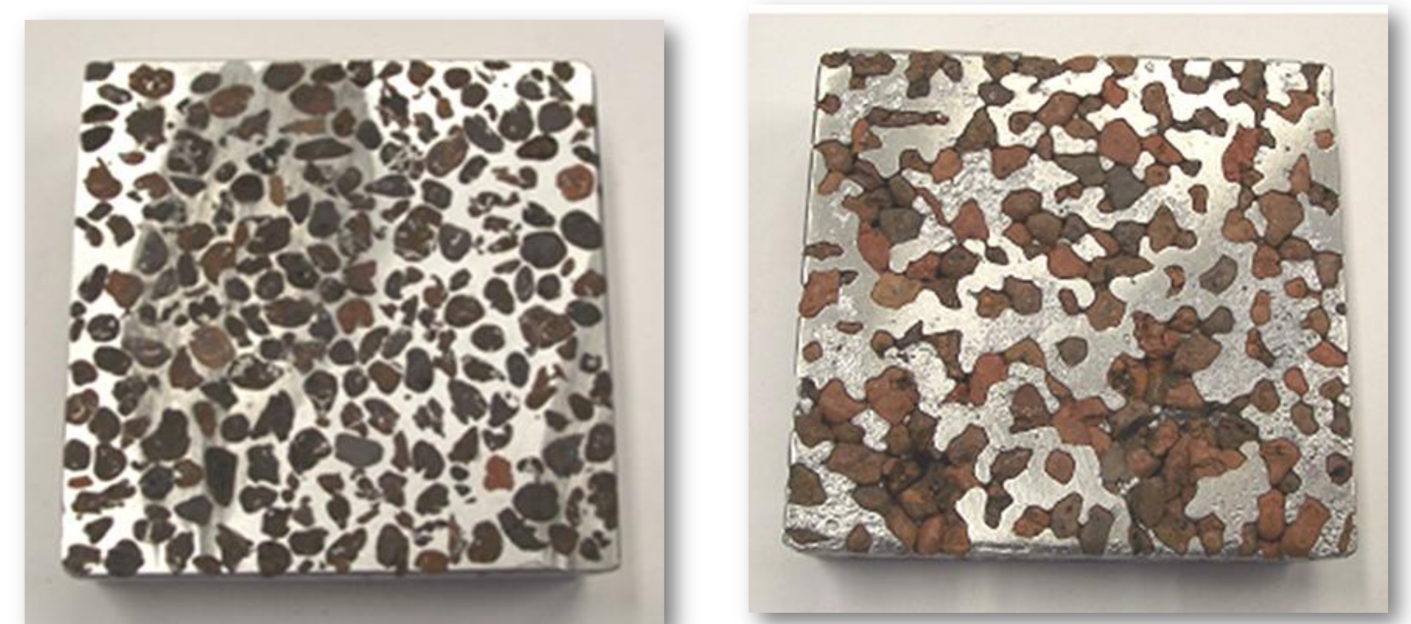
Fig. 4: Compósitos da liga AA7075 com cinasita obtidos por tixoinfiltração.
