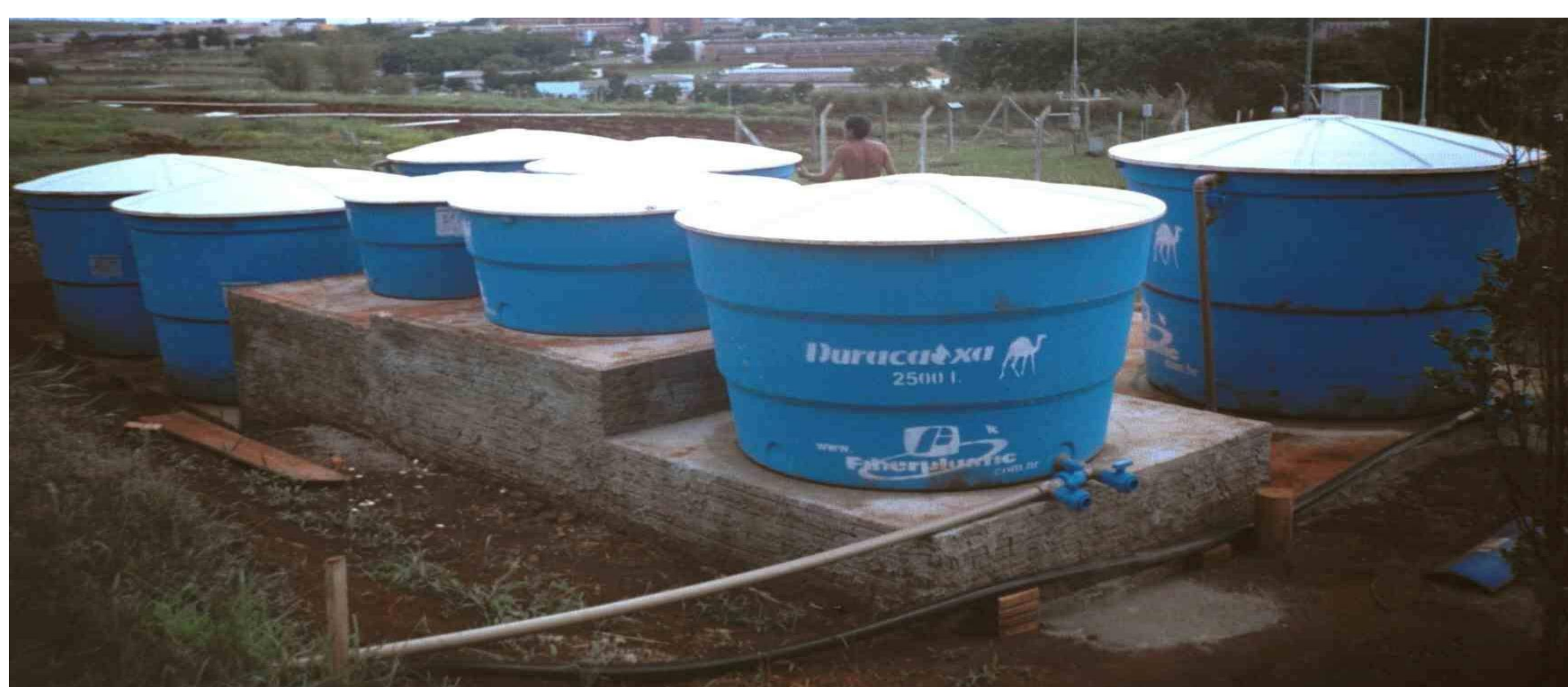
Figura 2 - Foto do sistema modular (RAC e FAs) instalado no campo experimental da FEAGRI/UNICAMP.
