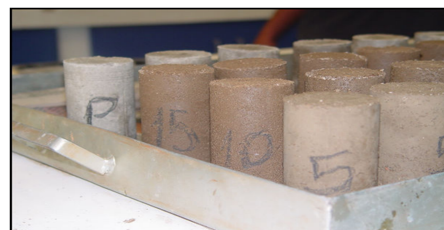
Figura 1. Corpos de prova com a incorporação de 5% de lodo, 10% de lodo, 15% de lodo e o Padrão.
