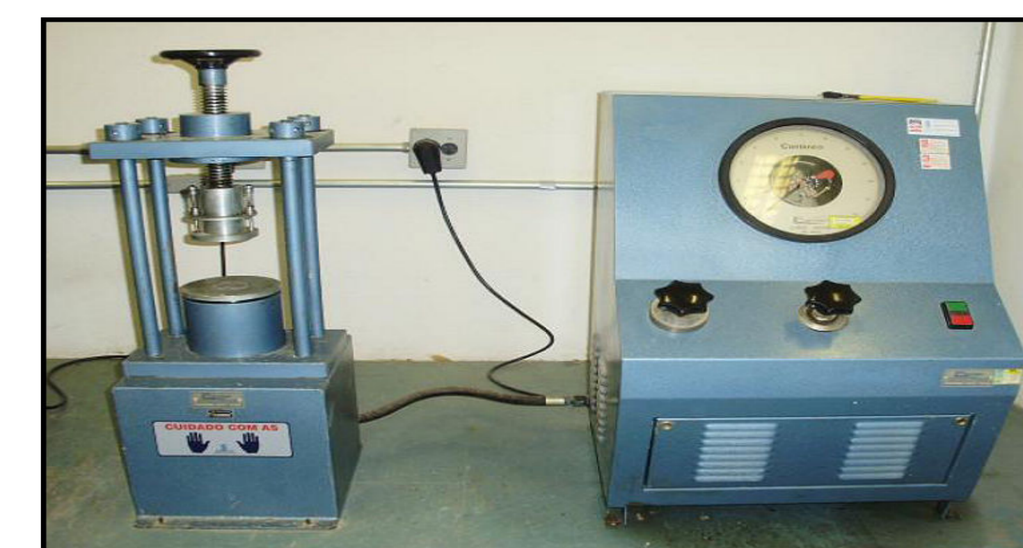
Figura 2. Máquina de ensaio de resistência a compressão.
