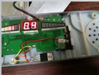
Sistema em funcionamento, detectando obstáculo à 0.4m
