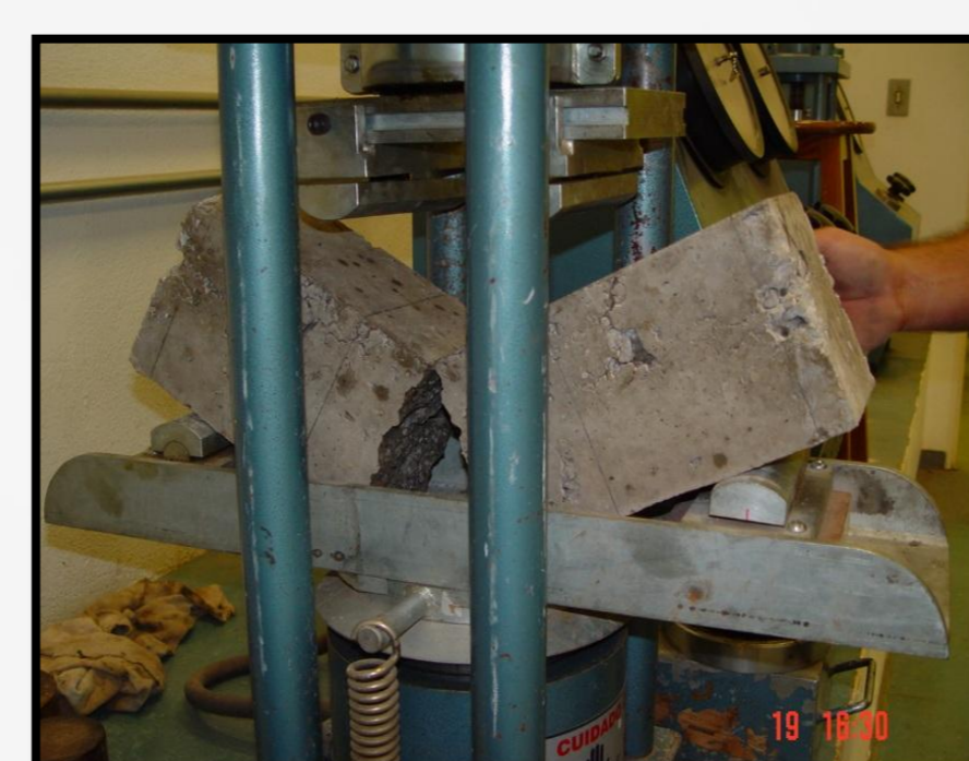
FIGURA 5 : Ensaio de Tração na Flexão. (NBR 12142)
