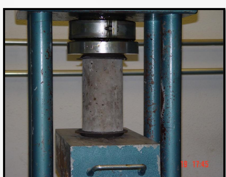
FIGURA 3 : Ensaio de Compressão Axial. (NBR 5739)
