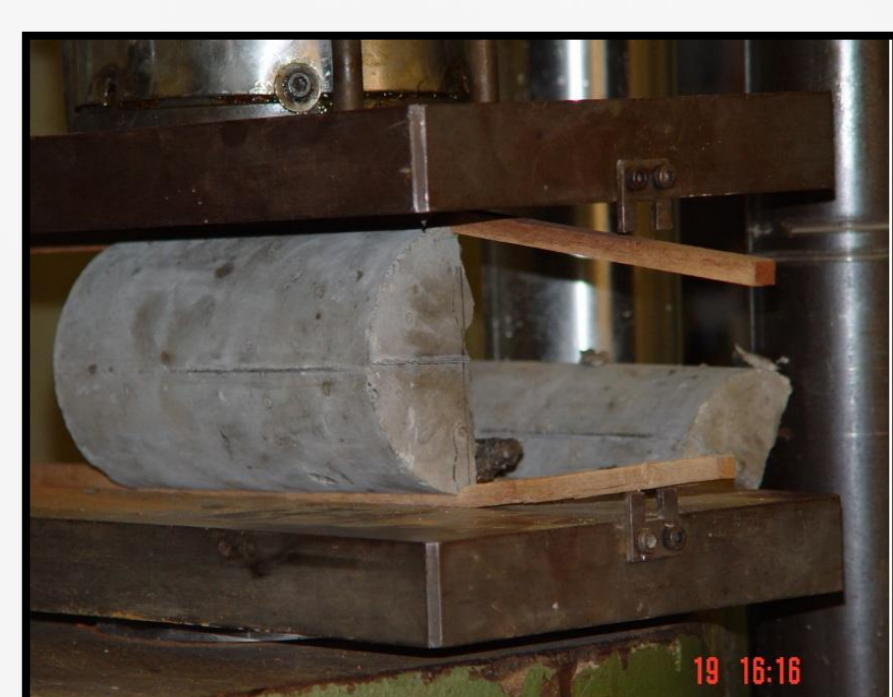
FIGURA 4 : Ensaio de Tração por Compressão Diametral. (NBR 7222)
