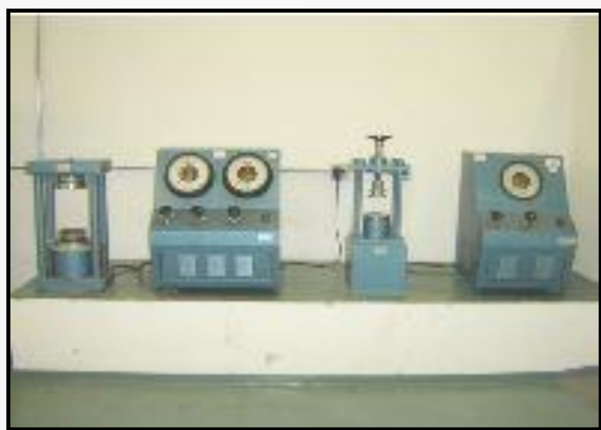
FIGURA 1: Prensa usada para ensaio de compressão
