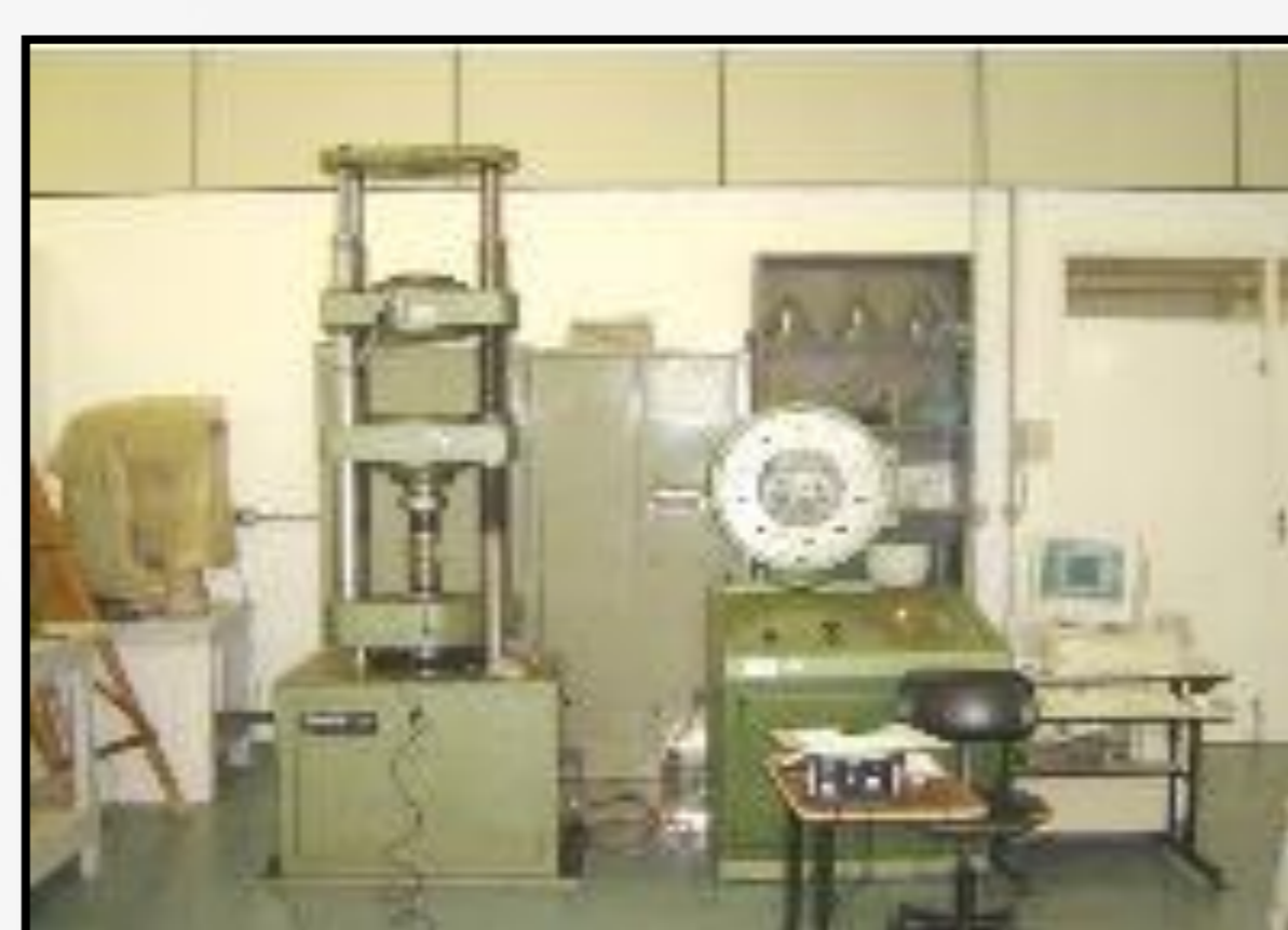
FIGURA 2: Prensa usada para ensaio de tração
