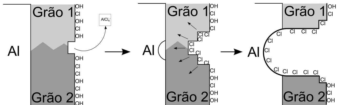
Mecanismo para a despassivação do alumínio por íons cloreto. Um mecanismo semelhante ocorre com hidróxido, mas neste caso, há a repassivação.<sup>3</sup>
