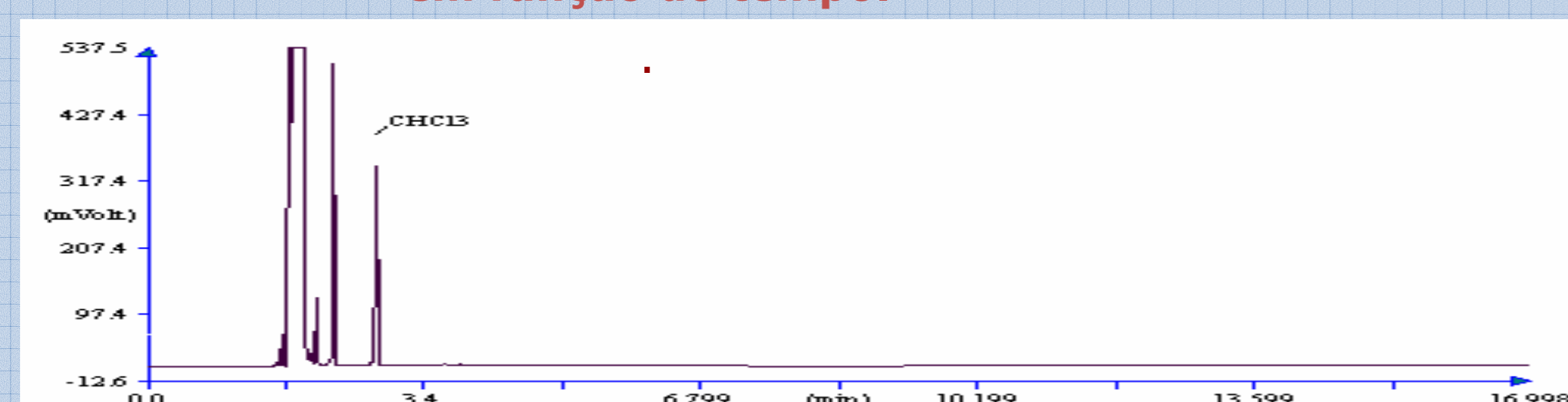
Figura 2. Cromatograma da solução padrão de clorofórmio em pentano.
