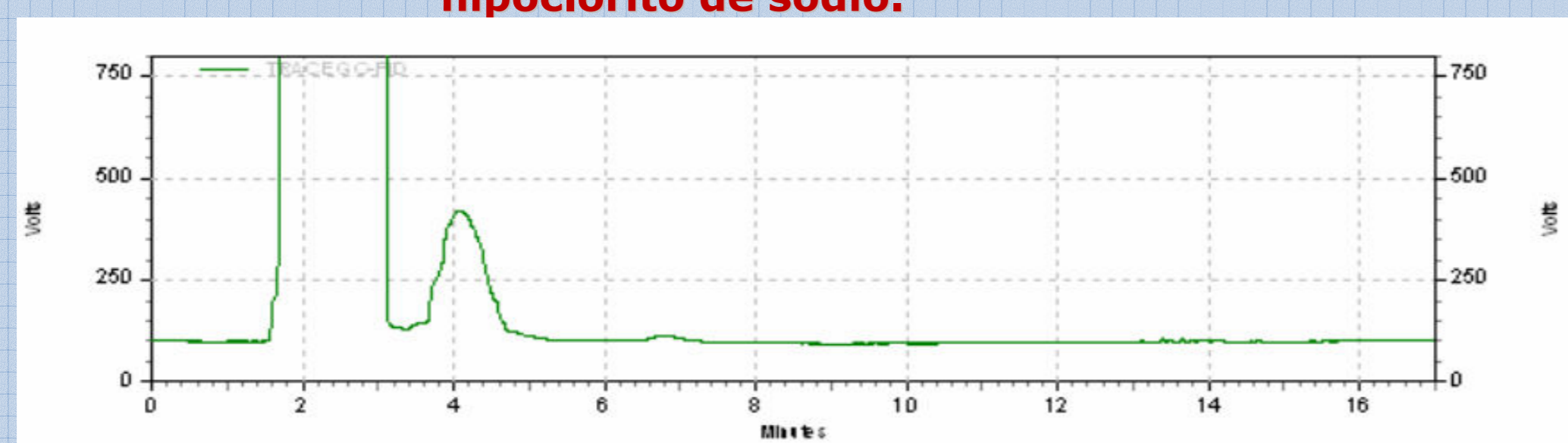
Figura 3. Cromatograma da amostra da Válvula difusora, com ensaio de desinfecção utilizando o Dióxido de cloro, utilizando o detector FID.
