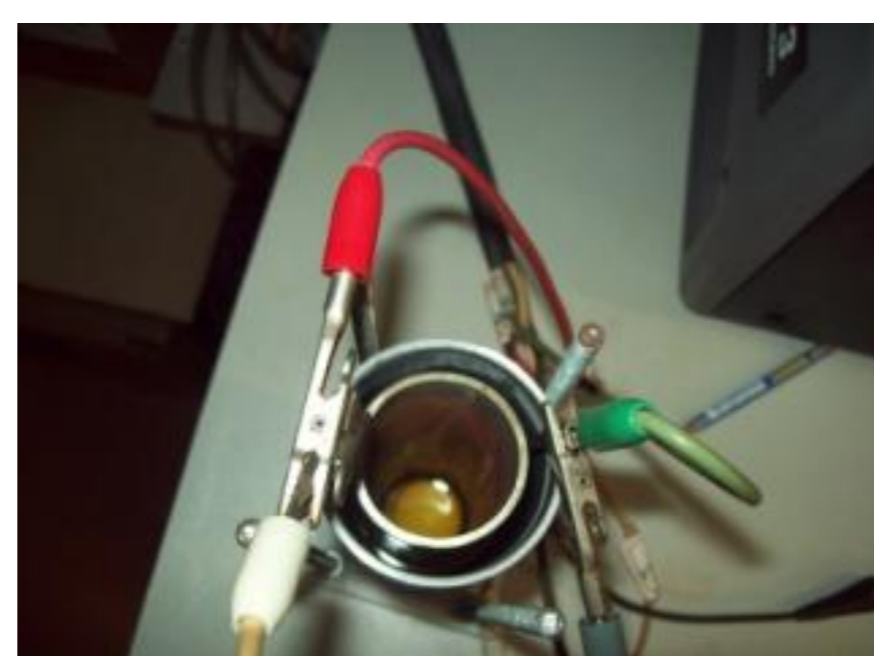
Figura 2: Célula de aço conectada no Eletrodo de trabalho (verde) e o Contra-eletrodo (vermelho)
