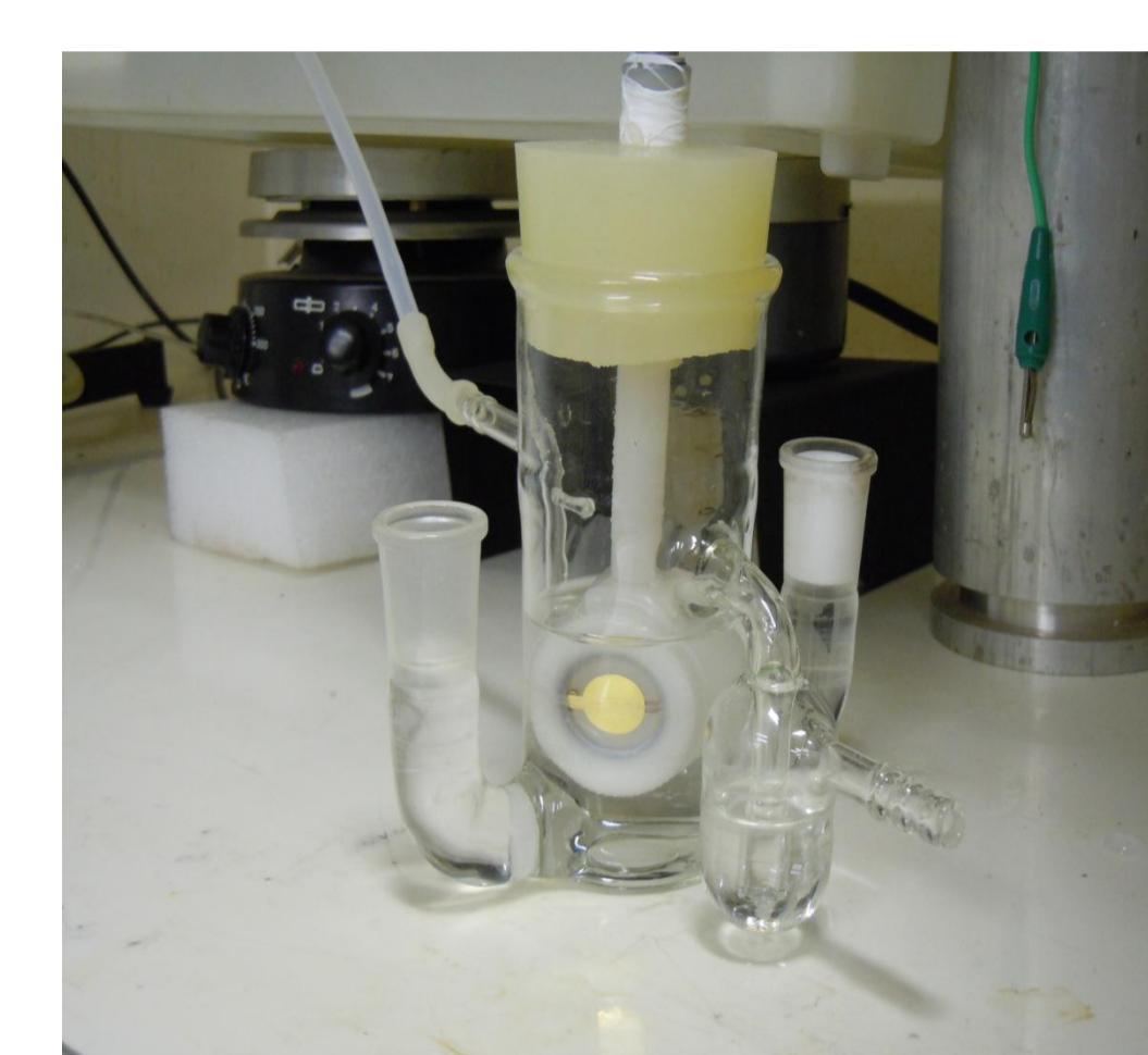
Figura 9: A EQCM imersa em solução ácida dentro da célula utilizada.
