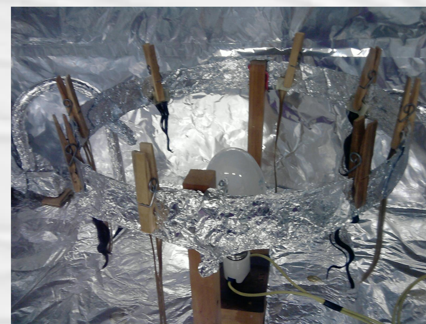
Figura 2: Montagem para exposição de mechas à radiação proveniente da lâmpada de vapor de mercúrio.
