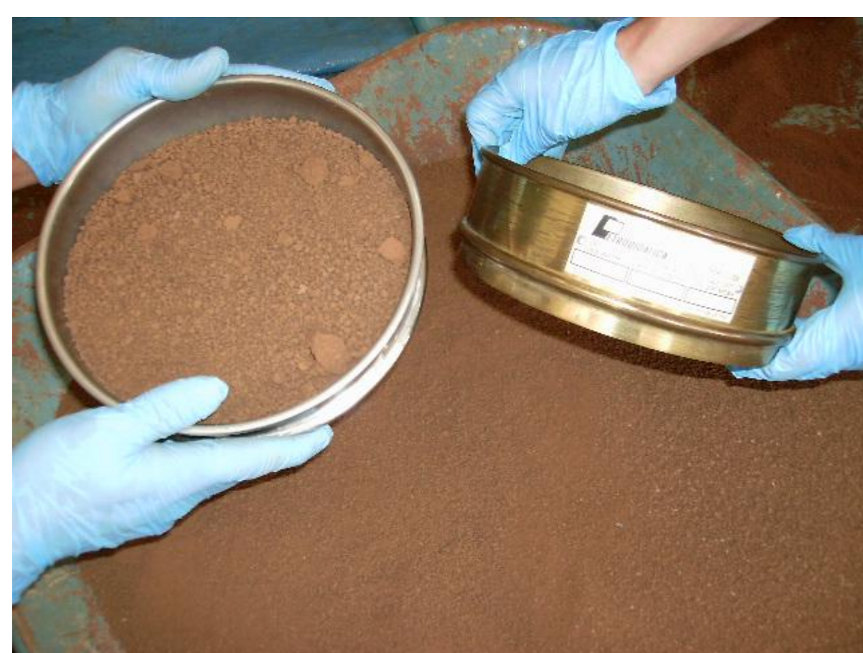
Figura 1 – Peneiramento do lodo.
