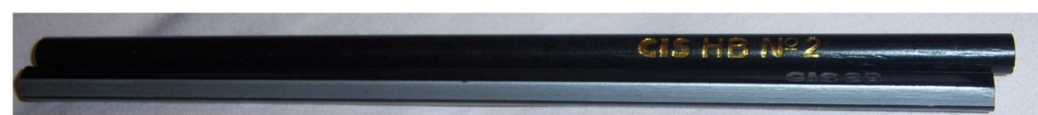
Figura 2 – Fotos dos lápis utilizados, sem pontas, para permitir a determinação da resistividade através de medidas de resistência.
