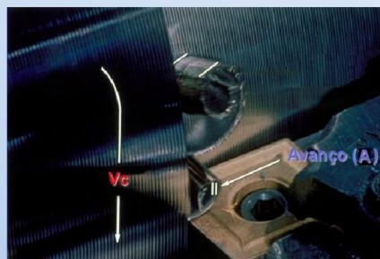
Figura 1: Processo de torneamento, indicação dos parâmetros utilizados.
