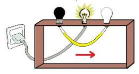
Acende-se uma lâmpada de 100 W próxima aos bulbos e equidistante deles. Como a quantidade de radiação recebida pelos bulbos são iguais, adquirirá maior pressão interna aquele que apresentar maior aquecimento, fazendo com que o líquido dentro do tubo mova-se na direção da seta vermelha, denotando a maior absorção da radiação incidente.
