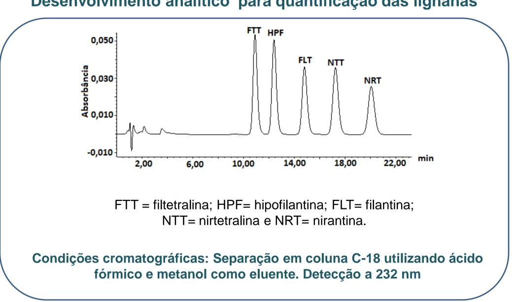
Validação do método de quantificação das lignanas utilizando HPLC com detecção a 232 nm.
