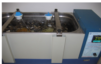
Figura 1. Banho-maria com sistema de agitação e termostato
