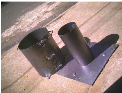
FIGURA 1 – Fôrmas projetadas e construídas para a concretagem dos protótipos de postes
