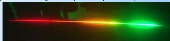
Fig. 2: Espectro do laser Ti:Sapphire após passar pela fibra fotônica e difratar em uma rede de difração.
