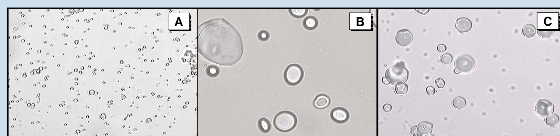
Figura 2: Grânulos de amido de cana de açúcar (A), amido de batata (B) e amido de mandioca (C) (aumento de 400x).
