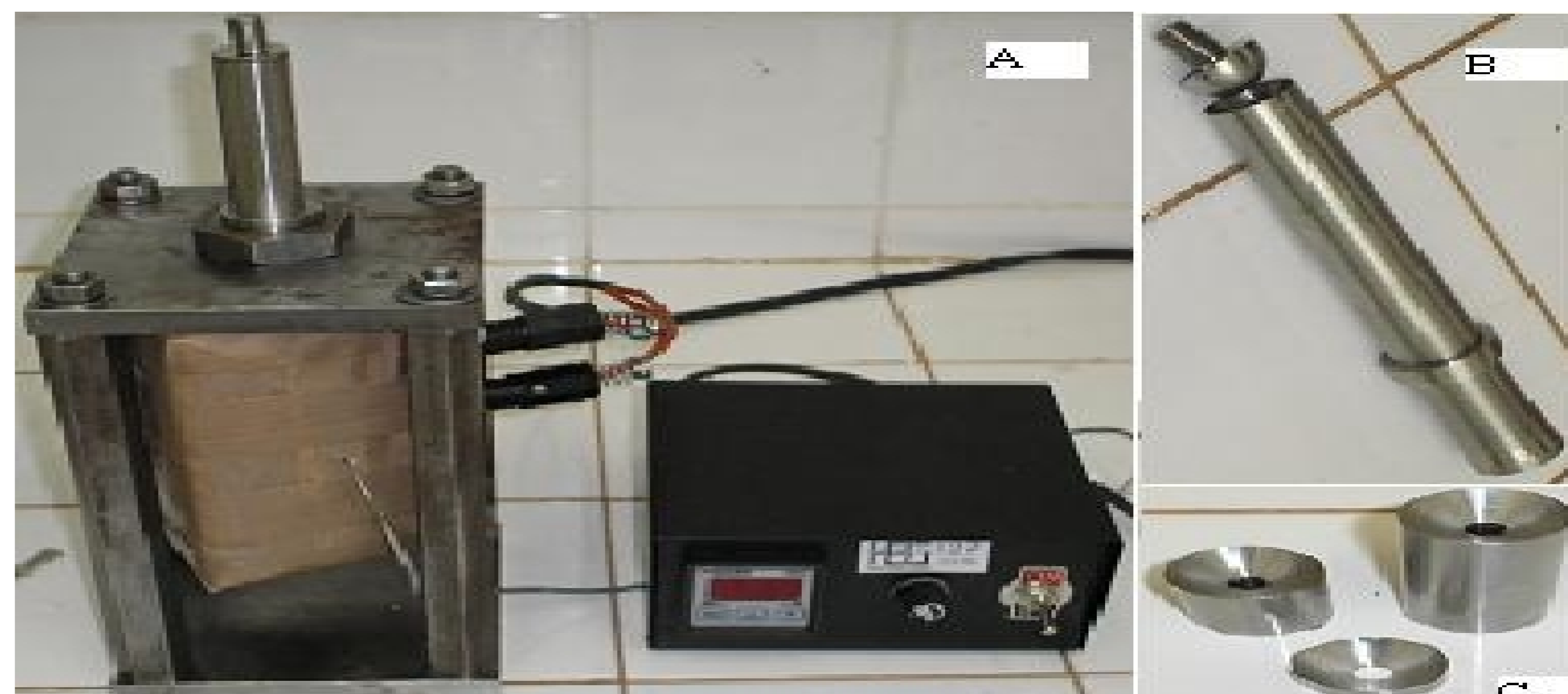
FIGURA 2: A) Reômetro capilar, resistência elétrica e controlador digital de temperatura; B) Pino e anel de alinhamento do pistão e pistão; C) Matrizes de diferentes tamanhos.
