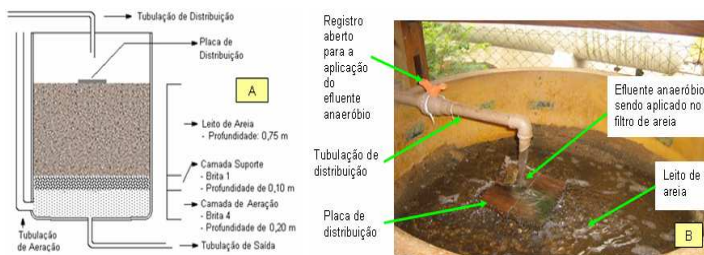
Figura 2 - Esquema (A) e foto (B) de um filtro de areia.
