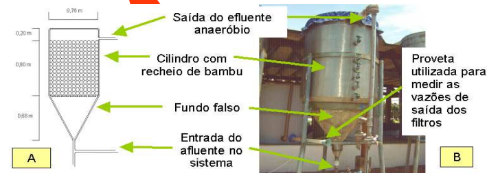
Figura 1 - Esquema (A) e foto (B) de um filtro anaeróbio com recheio de bambu.
