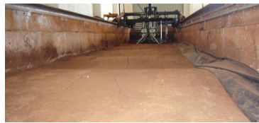
Leito de solo preparado com ondas senoidais de amplitude de 50 mm e período de 1,5 m para a realização dos ensaios.
