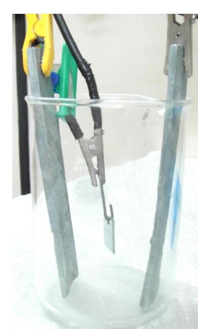
Figuras 1, 2 e 3 – Da esquerda para a direita: Montagem para produção dos eletrodepósitos, dos voltametrias e dos Tafel's com uso do potenciostato; Célula eletrolítica com anodos de zinco; e amostras de 2 x 2 cm com eletrodepósito de liga zinco/ferro sobre aço.
