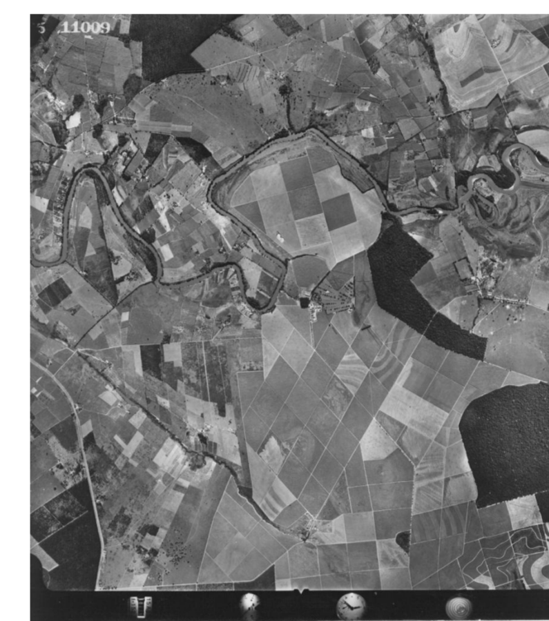
Figura 2: Exemplo de uma das fotografias aéreas do levantamento aerofotogramétrico utilizado como base para o mapeamento do uso e ocupação da terra do município de Paulínia no ano de 1964.
