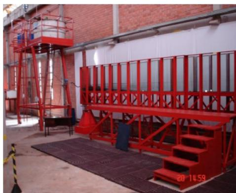
Figura 6 – Tanque simulando canal bidimensional. O fluxo entrou no tanque através de uma rampa com inclinação de 2,29°, e posteriormente fluiu sobre uma superfície plana. O fluxo inicialmente era mais denso do que o fluido presente na bacia receptora
