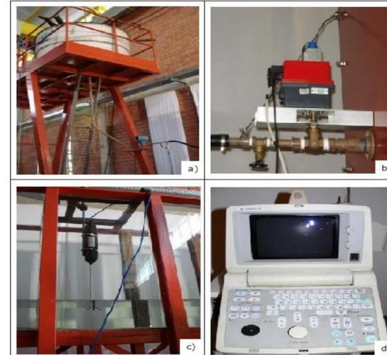
Figura 1 – a) Medidor eletromagnético de vazão; b) Controlador automático do registro de entrada; c) Sonda vetrino; d) Sonda de ultra-som médico.
