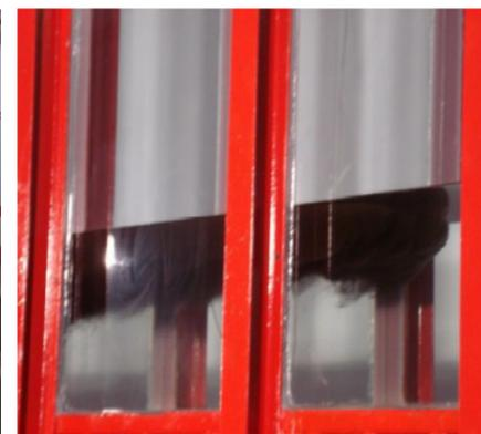
Figura 7 – Durante a passagem da corrente houve troca de calor entre os fluidos e deposição de sedimentos. Conseqüentemente houve mudança na relação de densidade entre os fluidos. A corrente tornou-se menos densa do que a bacia receptora, concentrando-se na porção superior (overflow).
