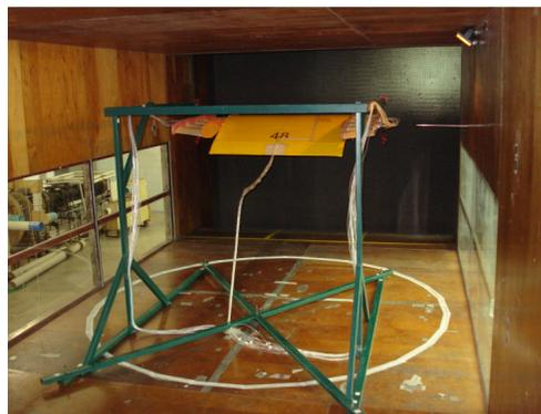
Figura 1: Interior do túnel de vento, com instalação da asa.
